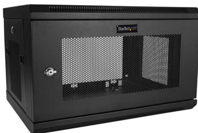
Cette armoire serveur 6U vous permet de monter votre équipement conforme à la norme EIA-310 au mur. Le boîtier dispose d'une profondeur de montage allant jusqu'à 37,6 cm et propose une capacité de charge maximale de 90 kg.
