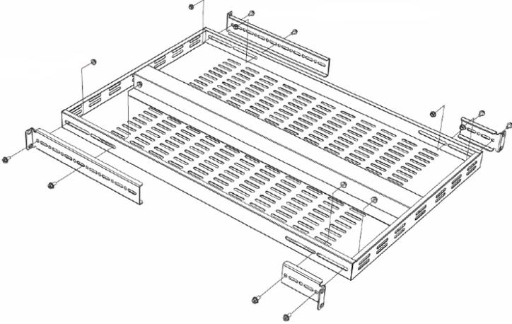
2. Utilisez les Vis M5 avec Rondelle (x8) pour monter le plateau sur la surface de montage du casier.
